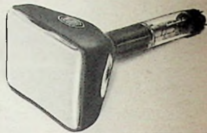
Bild 3. Die kleine Rechteck-Bildröhre M 17-69 der C. Lorenz AG
