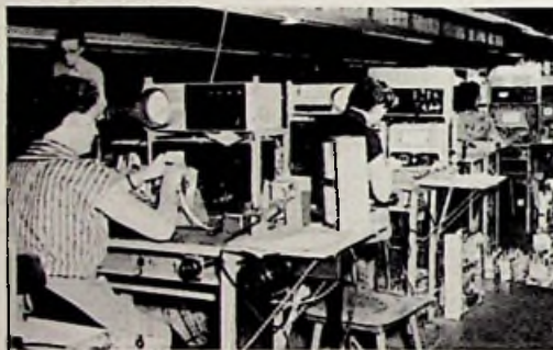
Bild 1. Abgleichen des Zf-Teiles von Fernsehempfängern im Werk Krefeld von Philips
