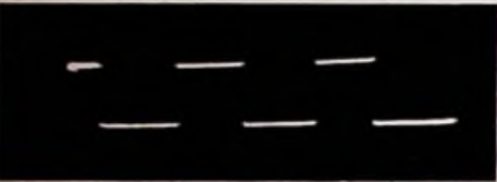
Bild 15. Spannungsverlauf an der Anode eines Hexodensystems
