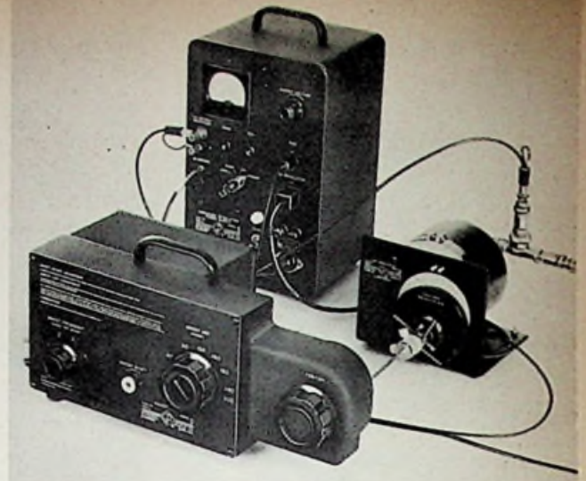
Bild 1. Aufbau eines Meßplatzes mit der Wobbeleinrichtung Typ 1750-A (vorn), dem Amplitudenstabilisator Typ 1263-A (hinten links) und einem Dezi-Meßsender (hinten rechts), dessen Abstimmknopf mit dem Wobbler gekuppelt ist
